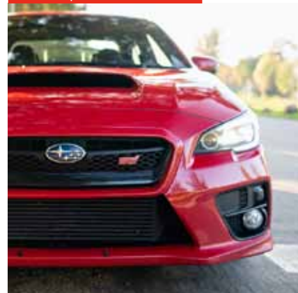
Kvůli většímu chladiči se musel výrazně rozšířit otvor ve spodní části nárazníku
